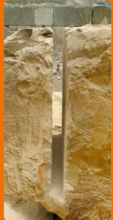
Beim Schneiden entstehen rechte Winkel und glatte Flächen. So lassen sich die fertigen Quader besser im Steinbruch lagern und später auf der Sägebank zerschneiden.
